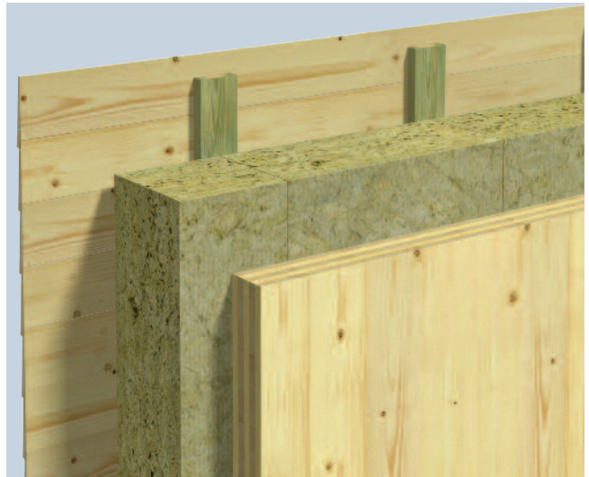
Figur 5. Massivtreelement med utenpåliggende trykkfast isolasjon.
