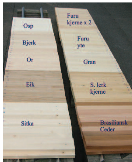
Figur 2. Double layer-prøver av forskjellige treslag. Nye til venstre og etter 7 år til høyre.
